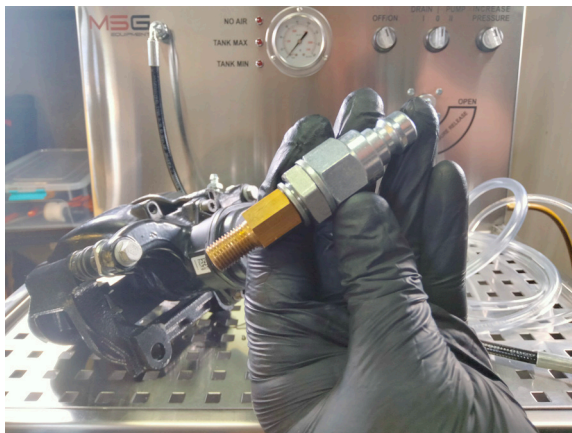
Рисунок 8. Штуцер і адаптер, підібраний під різьбу супорта
