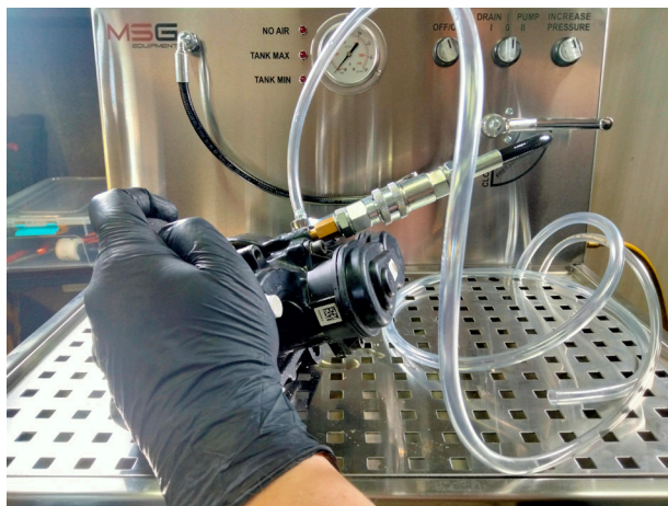
Figura 11. Tubería de PVC conectada para bombeo
