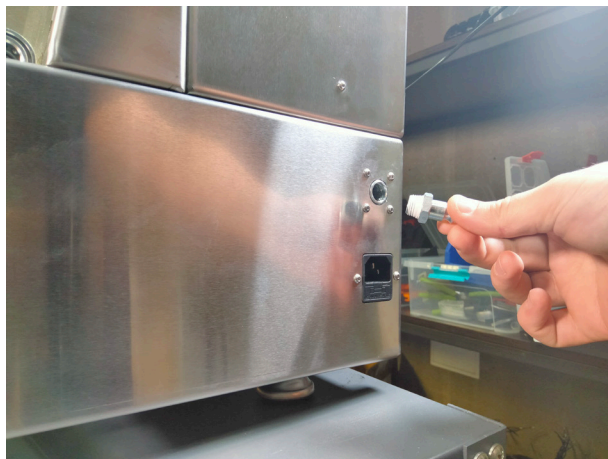
Rysunek 3. Montaż sztucera szybkozłączki do podłączenia źródła sprężonego powietrza
