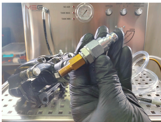
Figura 8. Boquilla y adaptador adaptados a la rosca de la pinza
