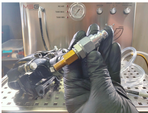
Рисунок 8. Штуцер и адаптер, подобранный под резьбу суппорта
